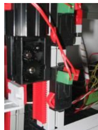
Detalle de los finales de carrera
