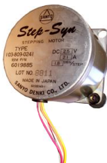
Figura 9: Aspecto exterior de un motor PaP. Se aprecian la placa de características y los seis conductores de salida (motor unipolar).
